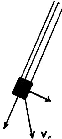
$$v_f = \sqrt{\frac{I_0}{m} \omega_0^2 \left[ 1 - \left( \frac{I_0}{I_0 + mR^2} \right)^2 \right] + 2gh}$$
